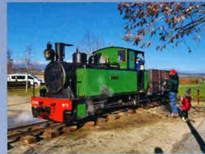
Sur le parvis, une machine en chauffe: la O30 T La Burgonde, une machine à voie de 60 du Chemin de Fer de la Vallée de l'Ouche.
