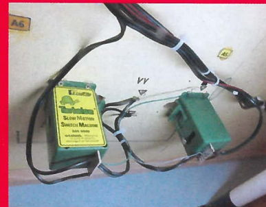
Les moteurs Tortoise sont dévolus à la commande des aiguilles.
