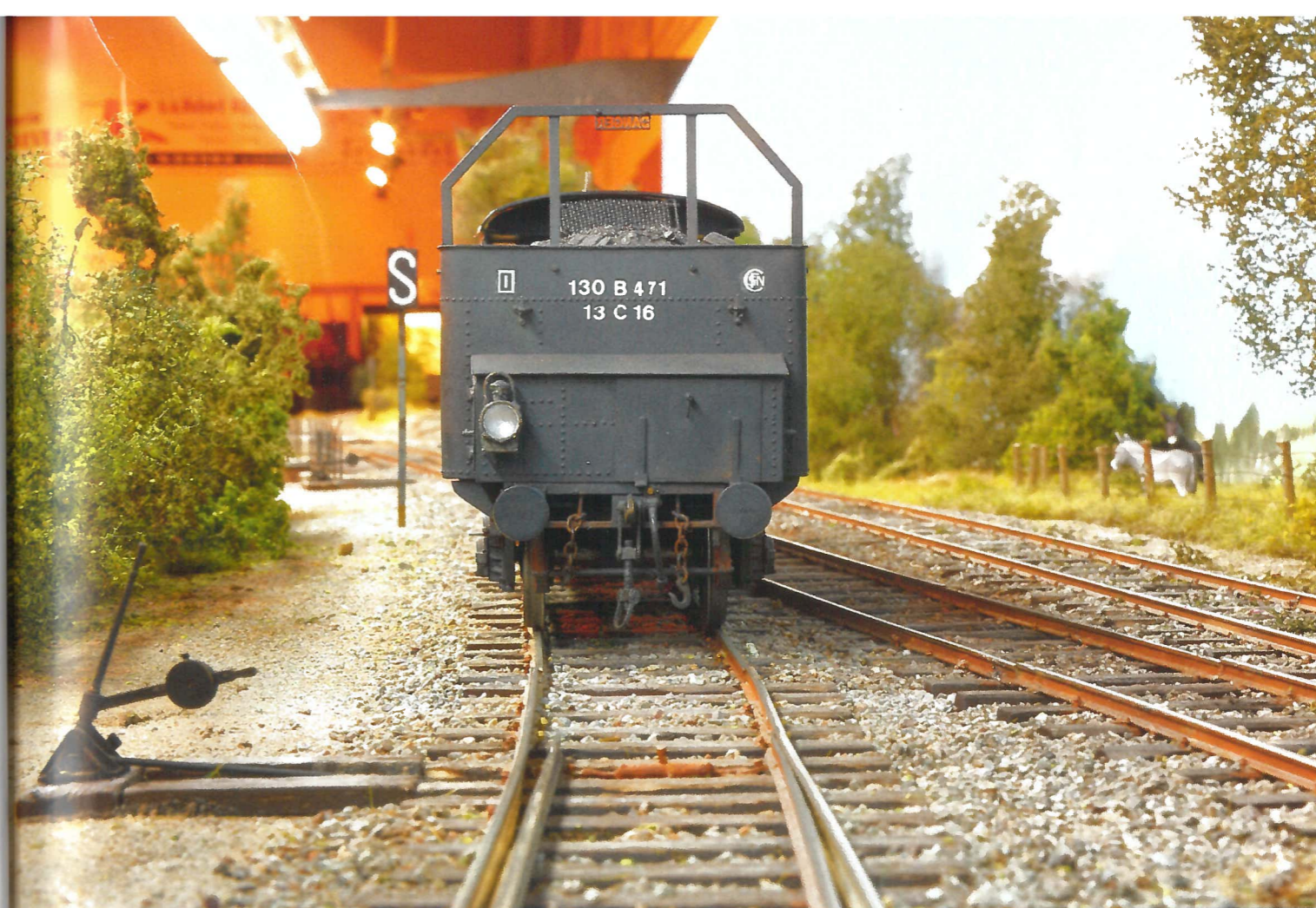
La 130 B siffle comme le lui impose la pancarte! Le signal imprimé a été collé sur une plaque de laiton soudée sur un morceau de rail. Le levier d'aiguille vient de la gamme Kit-Zéro.
