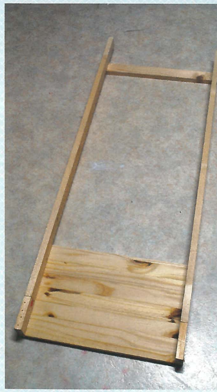
Les pieds sont facilement réalisés à l'aide de tasseaux et d'une planche de pin.
