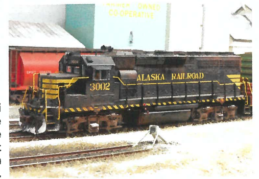
La neige sur le toit du wagon CN à l'arrière-plan est faite à base de plâtre de Paris tandis que celle du Rail Box provient de bicarbonate de sodium. Les coulures résultant de la fonte de la neige sont reproduites à l'aide de vernis brillant.
