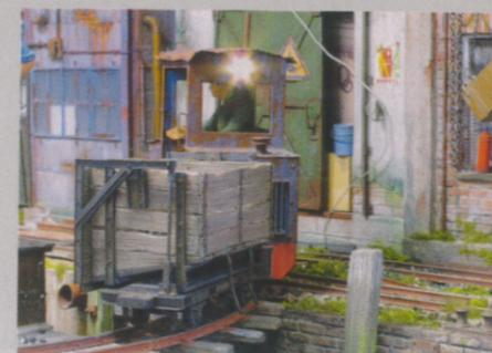
Le locotracteur pousse alors la berline vers la trémie de chargement dans la barge. On remarque sur la droite de la berline le levier qui actionne le système d'ouverture.
